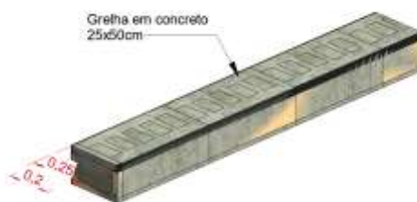
Detalhamento da vala de drenagem com tampa de concreto
