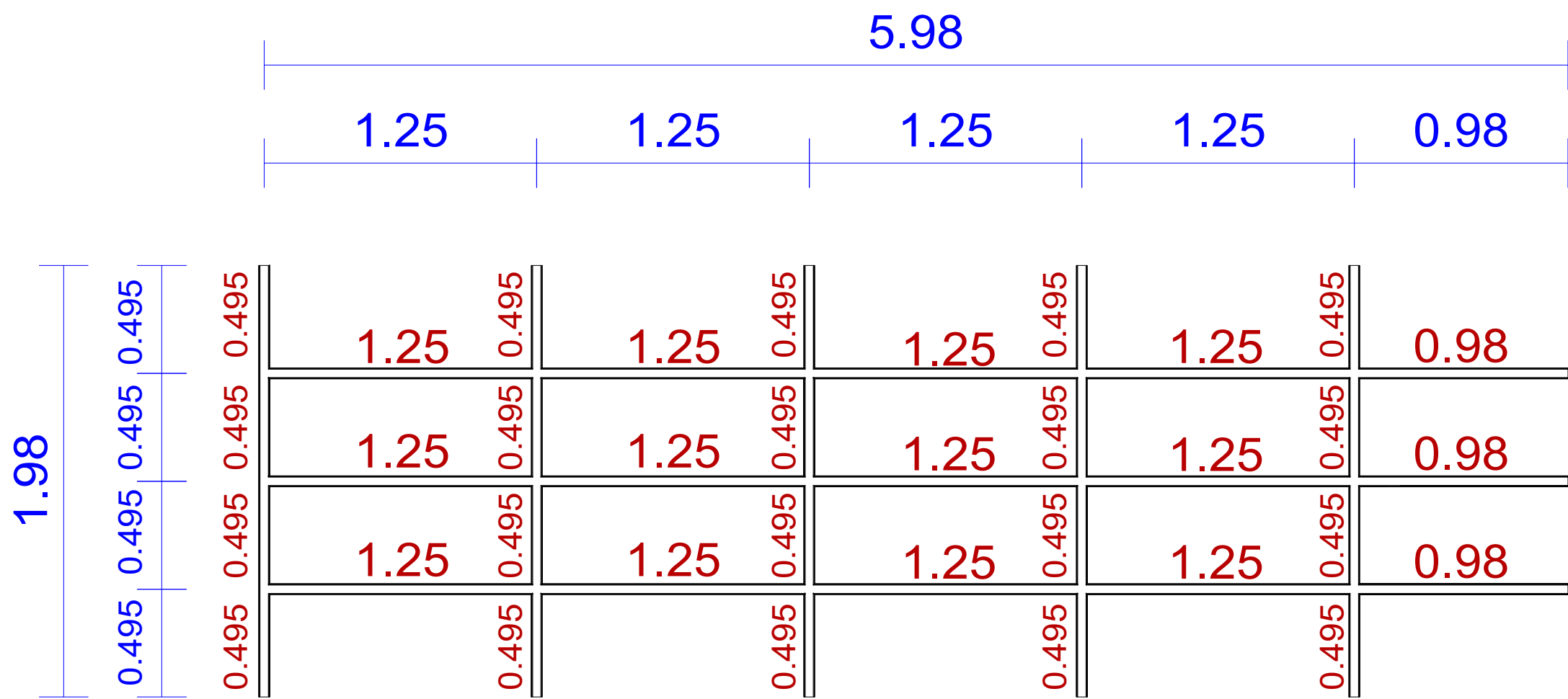
VISTA FRONTAL - ELEMENTO FACHADA - DIMENSÕES Escala:1:25 Cotas em (m)
